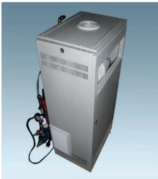
放射性污水净化的实验装置
