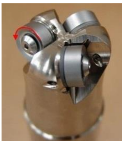
图. 高效加工难削材料钛的多刃工具
